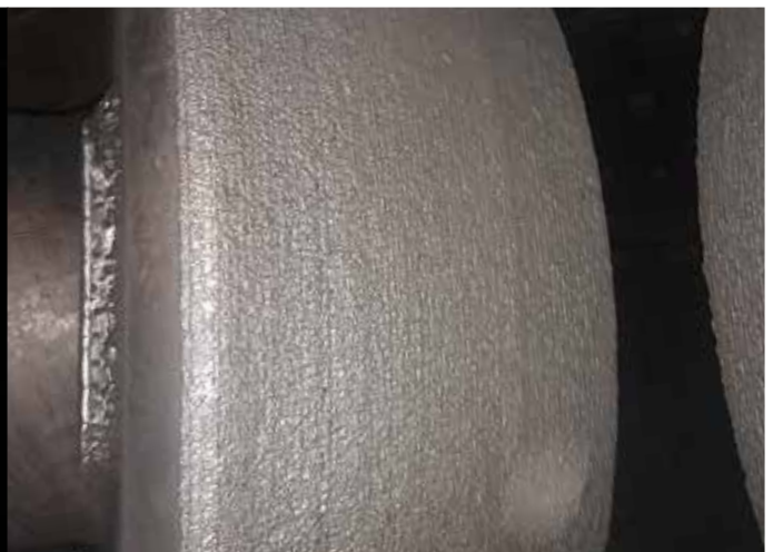
MillCarb™ nach 19.000 Betriebsstunden
