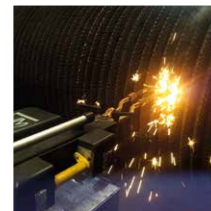
Azúcar: recargue duro de rodillo triturador
