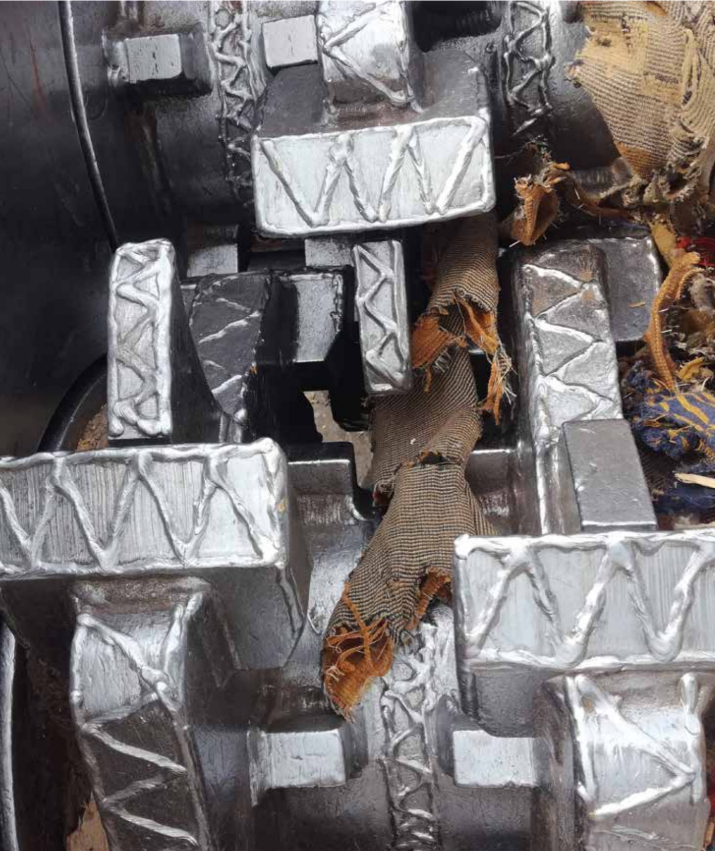
Operación de recargue in situ de trituradoras de reciclado mediante HARDFACE L-O.
