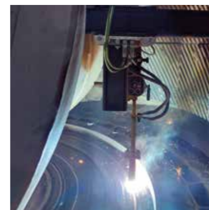
Cemento: recargue duro a mesa de molino
