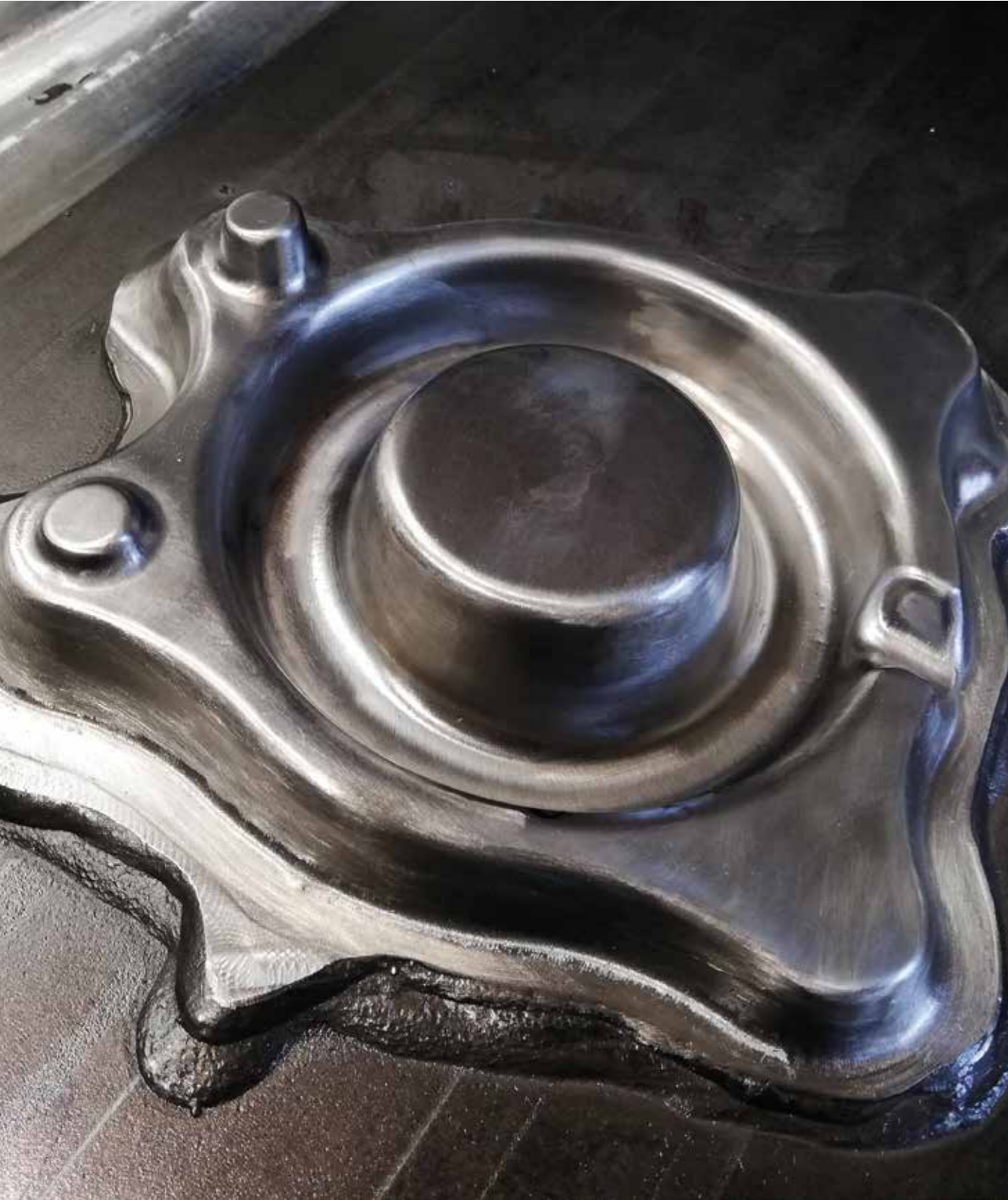
Fabricación de forja en matriz cerrada con HARDFACE W-G.
