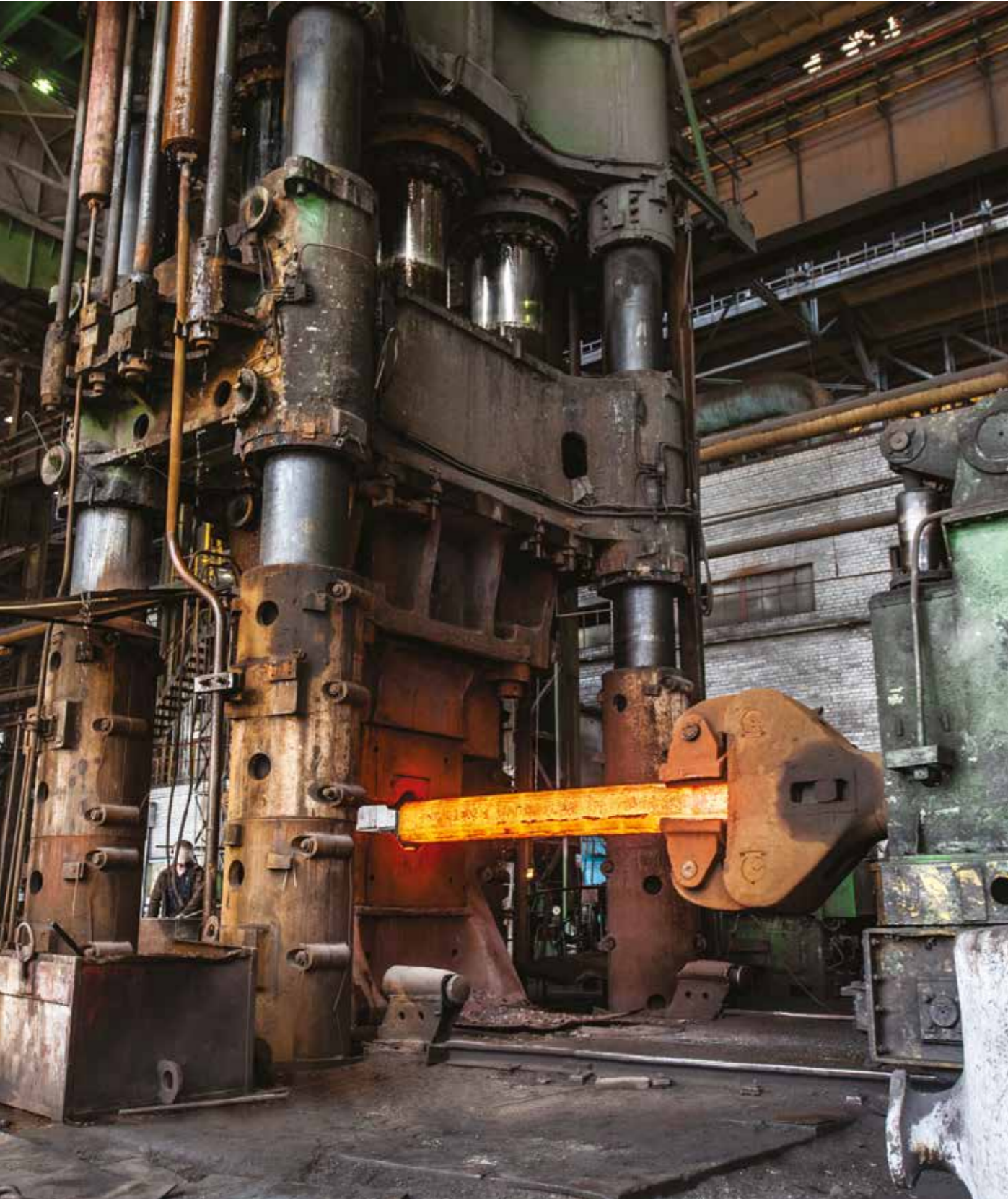
Proceso de forja en matriz abierta que muestra las matrices redondeadas con revestimiento duro de STELLOY Ni520-G.
