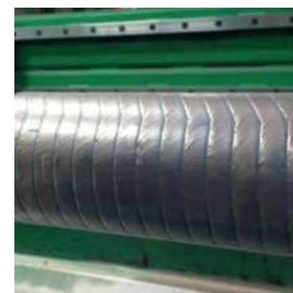
Acero: revestimiento inoxidable a rodillo de colada continua
