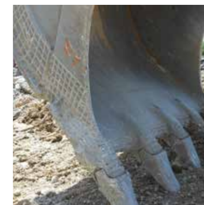
Minería: recargue duro de cuchara excavadora
