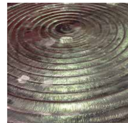
TETRA S 316L-G, unión de bridas en recipiente a presión
