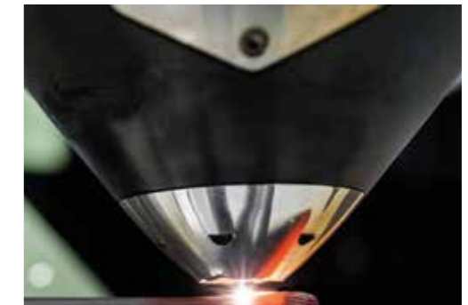
Tête laser à fil coaxial
