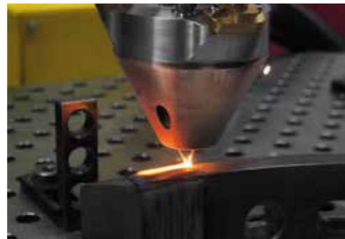
Tête laser à alimentation latérale multi-fils
