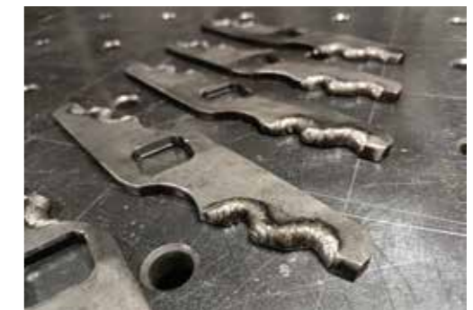
Couteaux rechargés avec le HARDFACE NICARBW-LD
