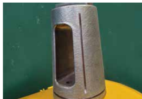
Placage d'une vanne à boisseau conique avec le STELLOY 6-LD
