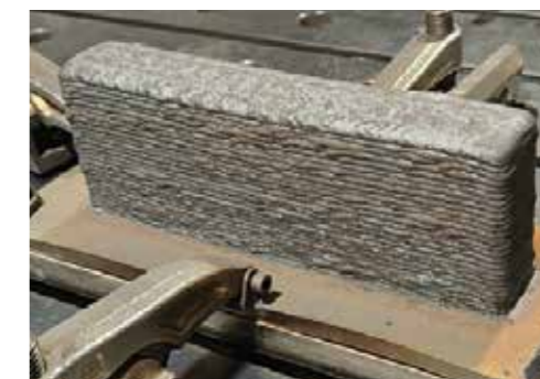
Mur réalisé par fabrication additive pour la qualification du CHROMECORE M 410NiMo-G
