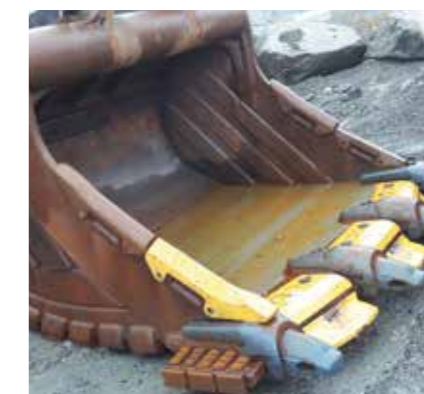
Estrazione: benna per escavatore con rivestimento antiusura
