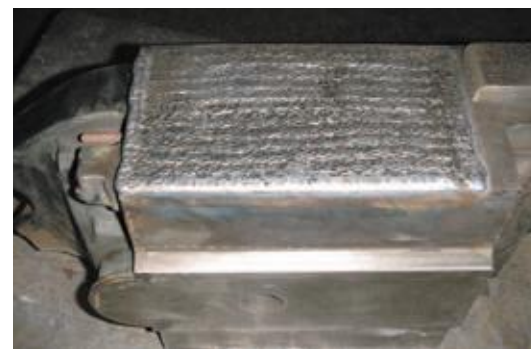
Outil d'injection d'Aluminium rechargé avec ROBOTOOOL 46-E
