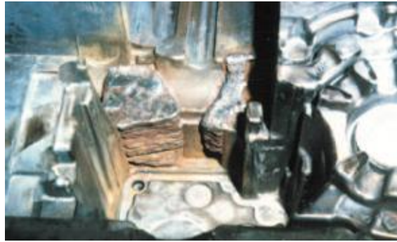
Réparation partielle d'un moule d'injection aluminium
