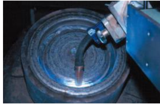
Rechargement total d'une empreinte en 1.2713 avec ROBOTOOOL 58-G
