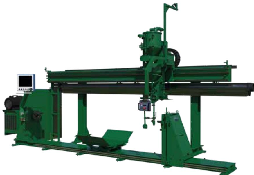
Cet automate de soudage pour le placage et le rechargement dur de rouleaux offre un matériel robuste et des niveaux de performance élevés, associés à notre logiciel d'exploitation avancé. Avec l'automate Roll Cladder, vous pouvez réaliser la soudure du tourillon, des marches et du corps du rouleau en une seule opération continue.
