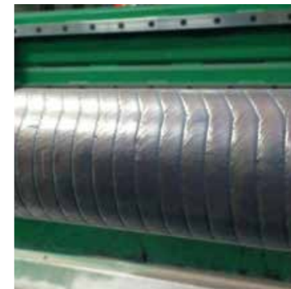
Sidérurgie : rouleaux de coulées continues rechargés
