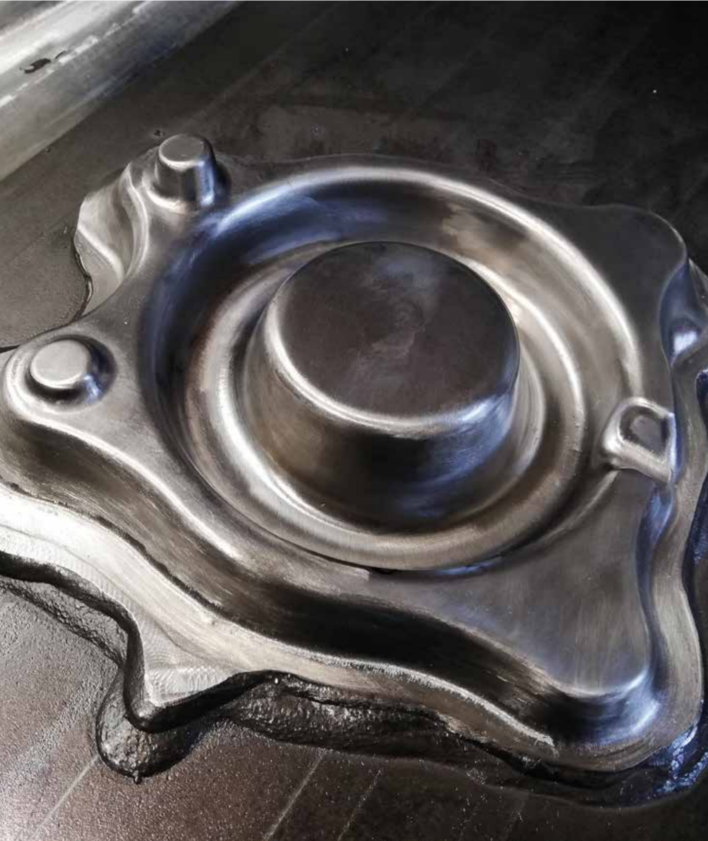
Fabrication d'une matrice de forge à l'aide du HARDFACE W-G.
