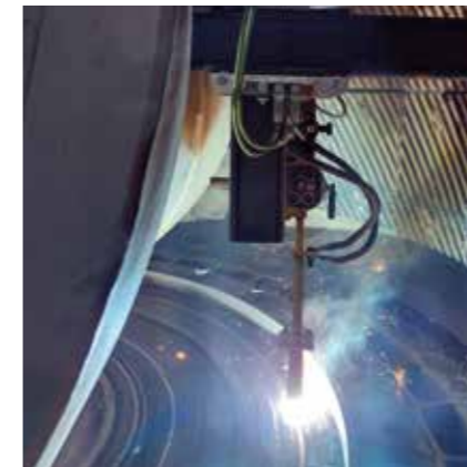
Cimenterie : rechargement dur d'une table de broyage
