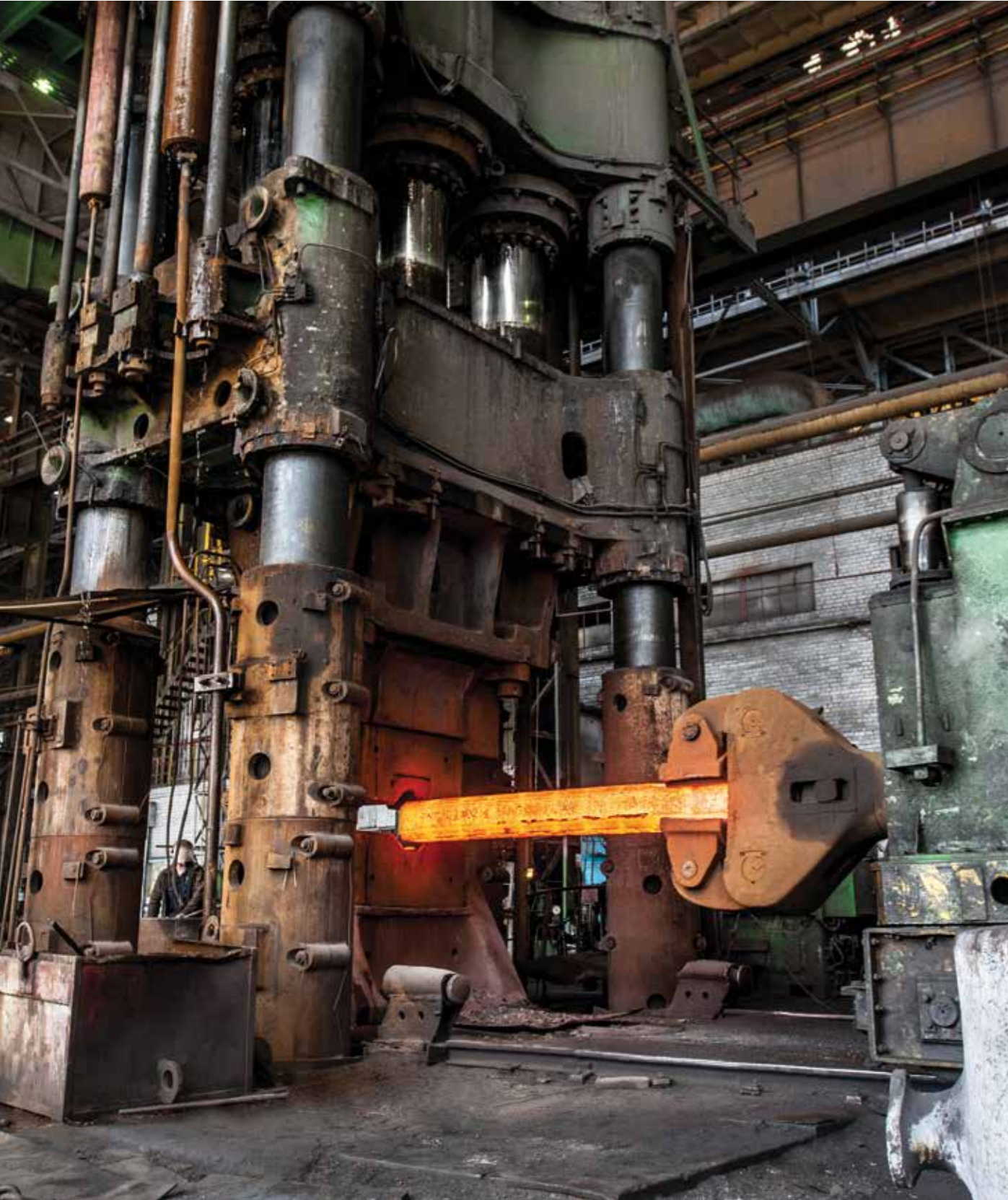
Forgeage libre montrant les outils rechargés avec du STELLOY Ni520-G.
