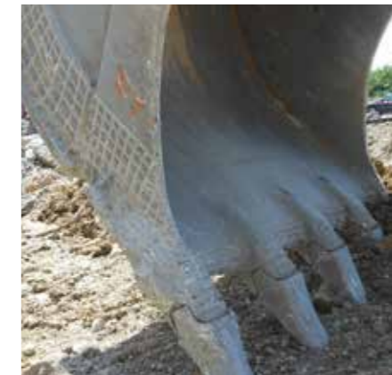
Mines : godet d'excavatrice rechargé
