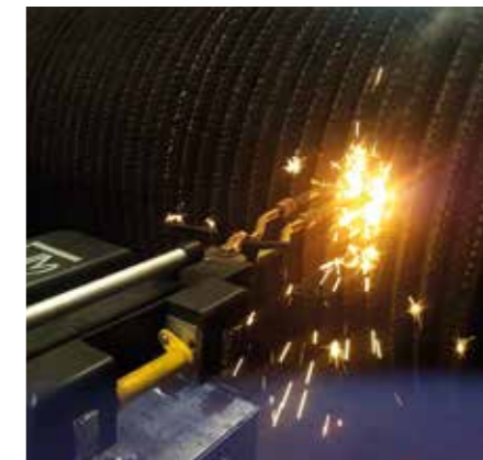
Sucrierie : rechargement dur d'un cylindre de broyage
