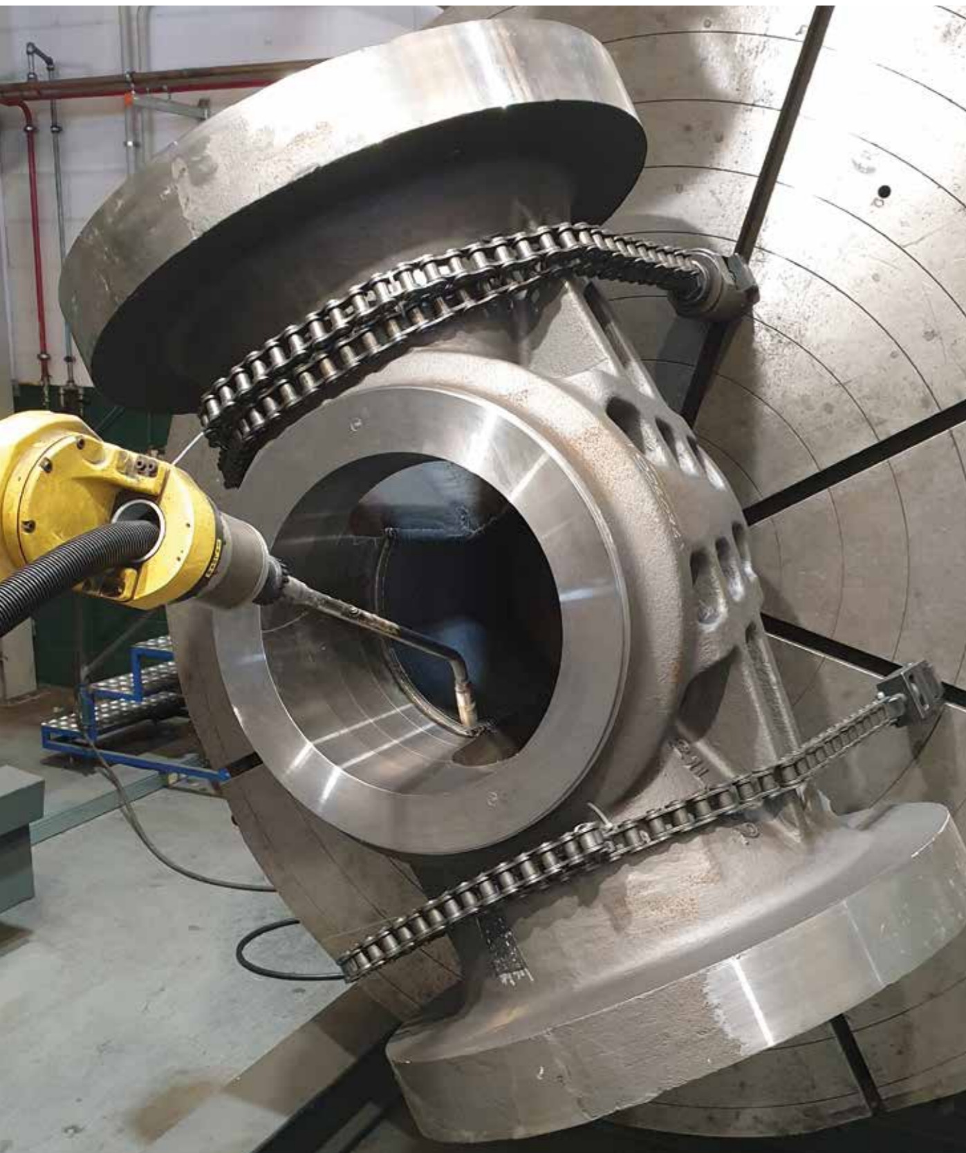
Rechargement robotisé d'une vanne à l'aide du STELLOY 21-G.
