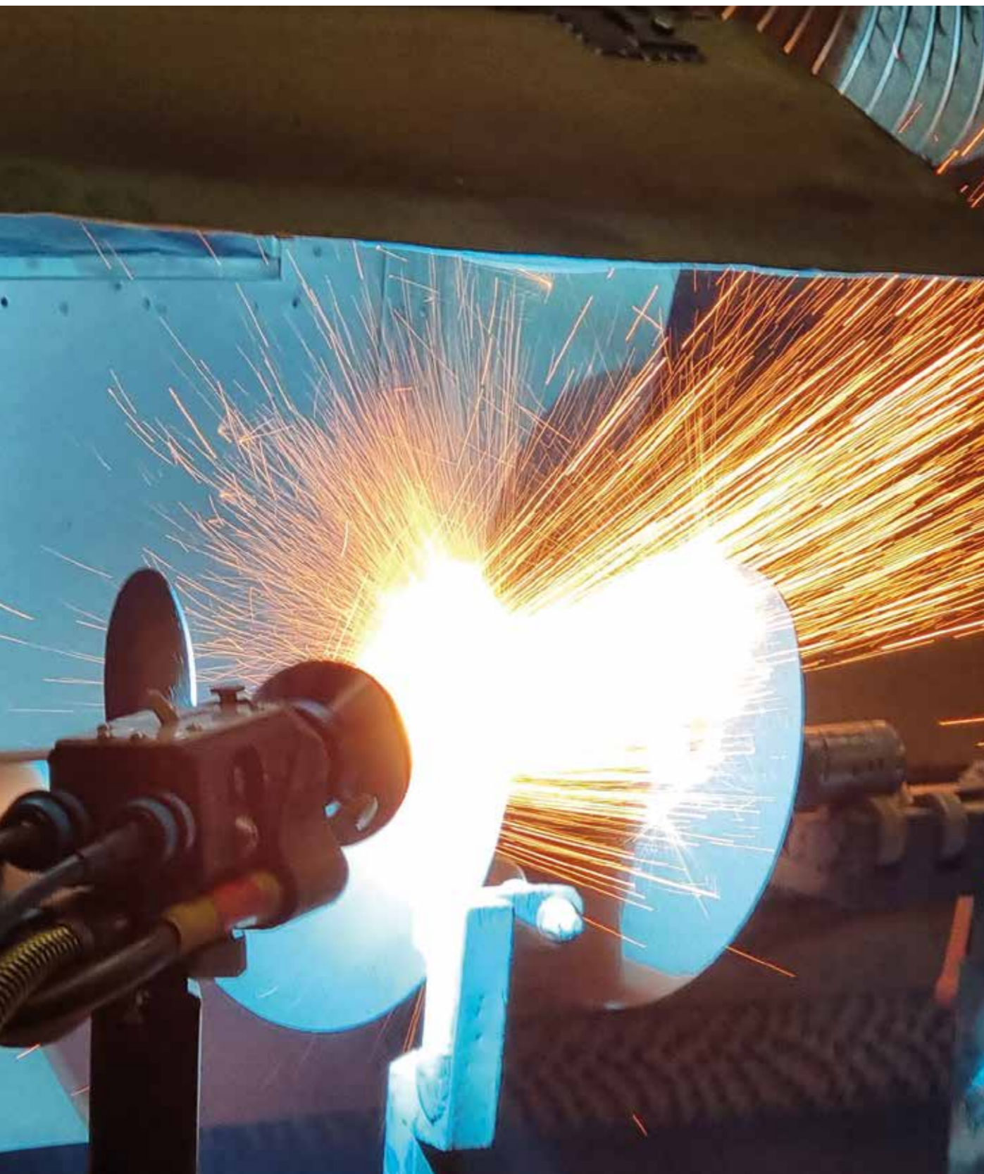
Revêtement dur d'une vis à l'aide d'un dépôt de fonte à haute teneur en chrome.
