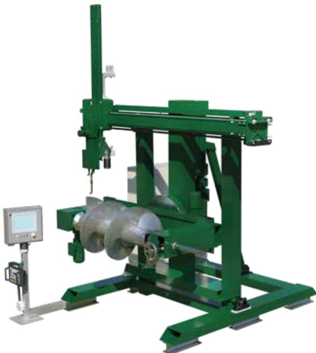
L'automate Screwflight est conçu pour plaquer les différentes parties d'une vis, dans toutes les positions, en permettant le soudage en position basse et avec des vitesses de production impressionnantes.
