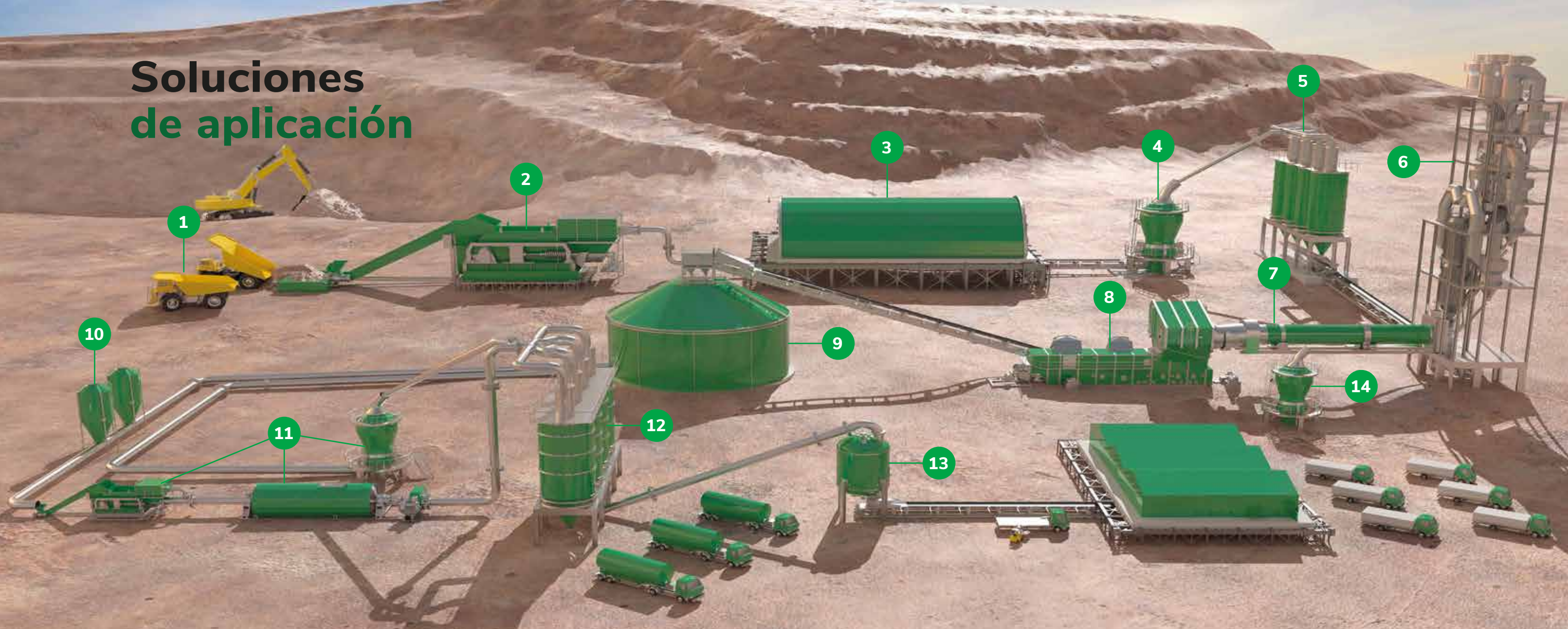
1. Cantera de piedra caliza 2. Trituradora 3. Existencias de piedra caliza 4. Molino de crudo 5. Silo de crudo 6. Precalen-tador/ calcinador 7. Horno 8. Enfriador de clínker 9. Silo de clínker 10. Silos de yeso y adi-tivos 11. Molino de cemento 12. Silo de cemento 13. Máquina envasadora 14. Molino de combustible
