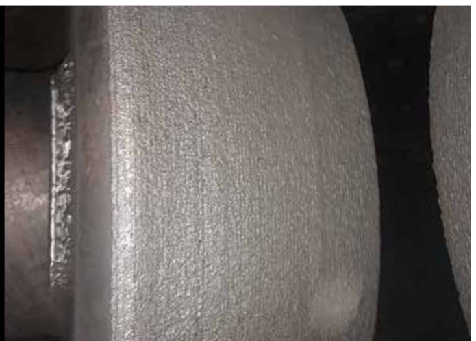
MillCarb™ après 19 000 heures de broyage
