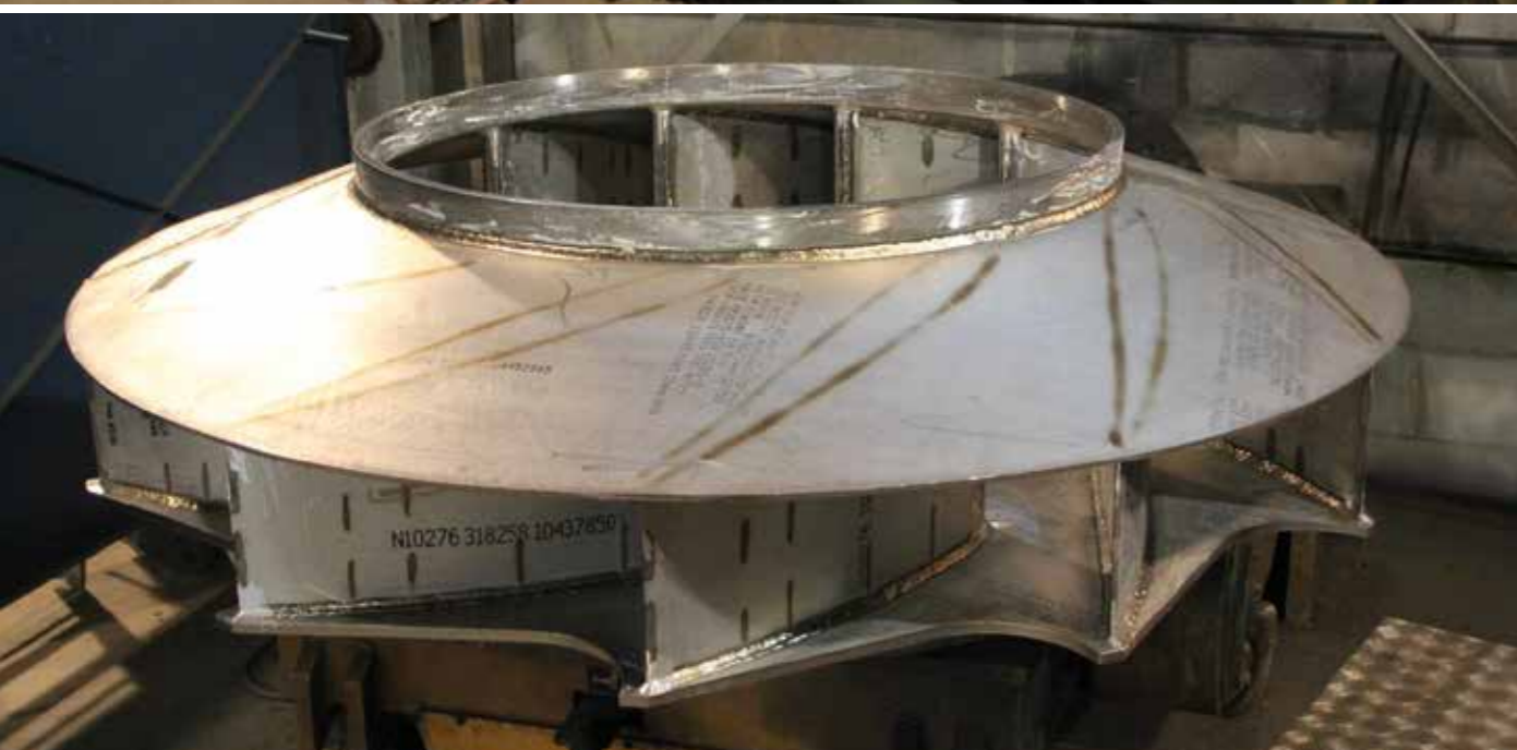
Fabbricazione di una ventola utilizzando GAMMA 276.
