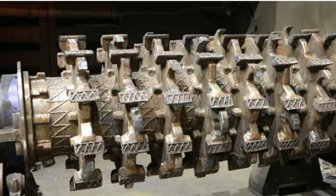
Welding Alloys fabrica una gama de consumibles diseñados específicamente para aplicaciones en la industria del reciclaje. Ofrecemos alambres tubulares con y sin costura, formulados para resistir múltiples tipos de desgaste por abrasión, impacto, fricción entre metales y altas temperaturas.
