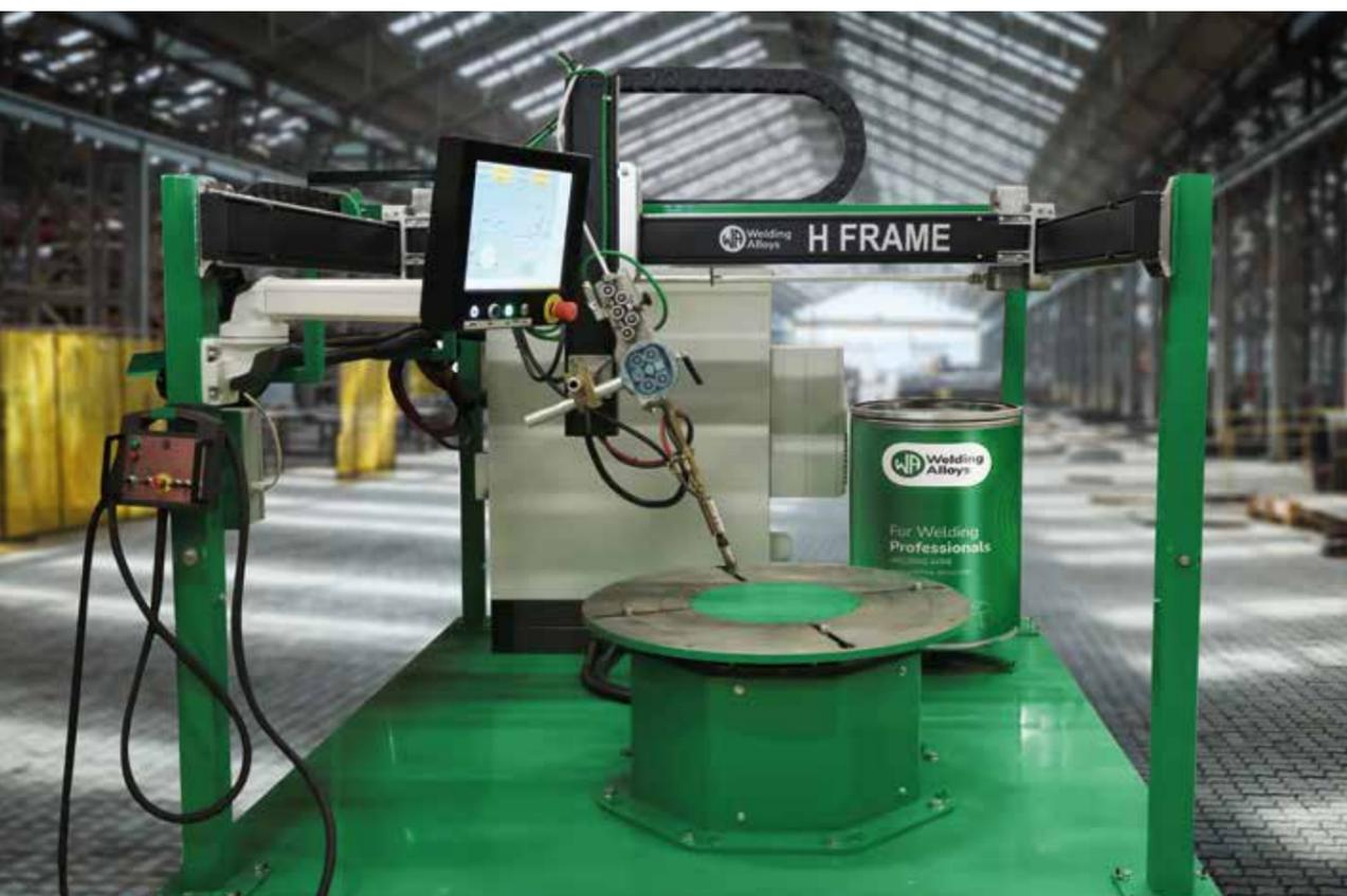
La automatización del proceso de soldadura puede mejorar la eficiencia al ofrecer reparaciones consistentes y de alta calidad, al tiempo que minimiza el tiempo de inactividad. Los clientes pueden beneficiarse de una amplia gama de equipos avanzados de soldadura de Welding Alloys, diseñados para el recargue, revestimiento, reconstrucción y unión de componentes.
